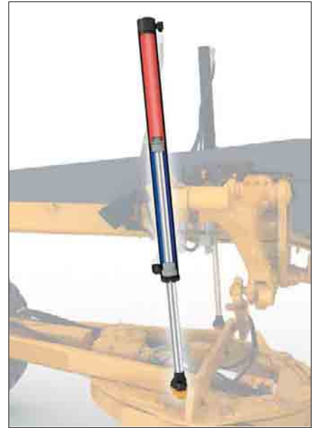
Identische Ein- und Ausfahrgeschwindigkeit der Zylinder durch Volumenstromanpassung
