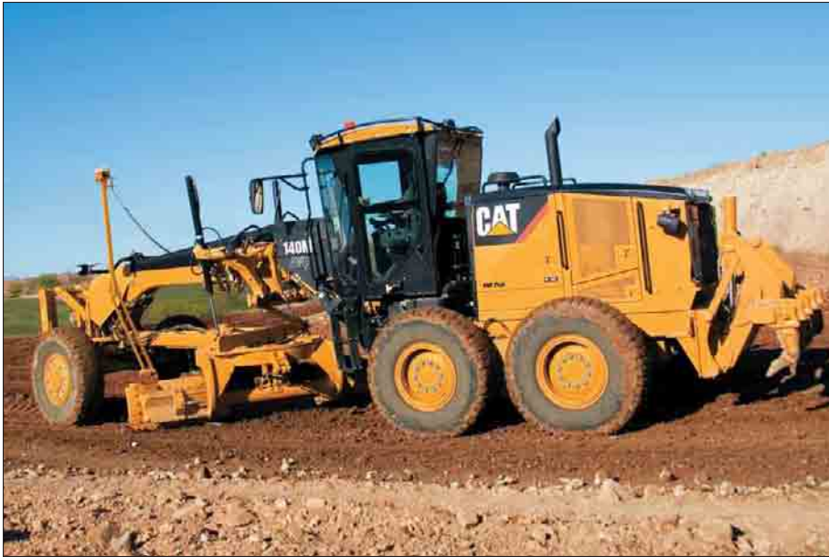
Motorgrader 140M mit AccuGrade™-Maschinensteuerung
