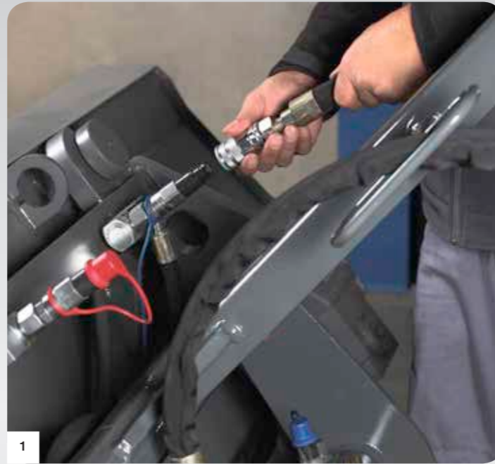
1 Einfache und sichere Anbindung des Anbaugerätes
